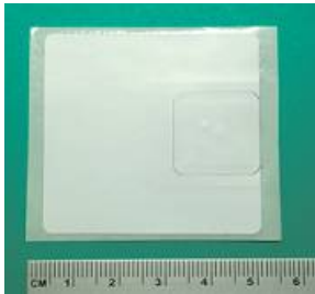
アンテナサイズ: L19×W19mm / ダミーラベル46×48mm
